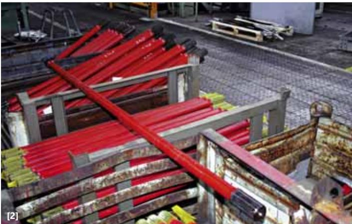
Практически лишь вариации длины только этих двух деталей ([1] – секция трубы, [2] – приводной вал) позволяют варьировать базу и длину рамы, а меняя их число (разумеется, мосты тоже нужны), можно изменять и колесную формулу от 4x4 до 12x12. Число управляемых осей может быть любым...
